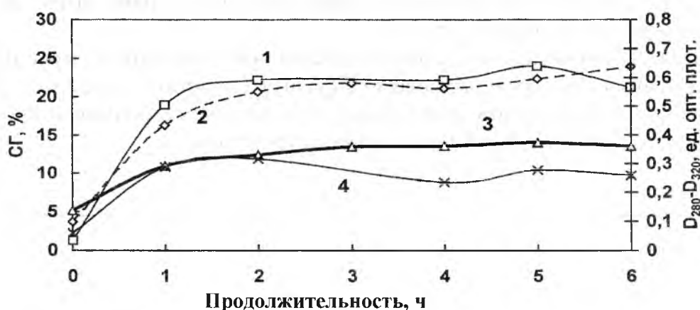
Рис. 6. Изменения степени гидролиза и содержания ТХУ-неосаждаемых белковых веществ в процессе гидролиза ОПГ. Условия гидролиза: рН 6,5; температура 50°C. Кормовой гидролизат (2 г ФП/ кг ОПГ; гидромодуль 1:0): 1 – оптическая плотность раствора в ТХУ; 3 – степень гидролиза. Осадок после гидролиза (6 г ФП/кг ОПГ; гидромодуль 1:1): 2 – оптическая плотность раствора в ТХУ; 4 – степень гидролиза
