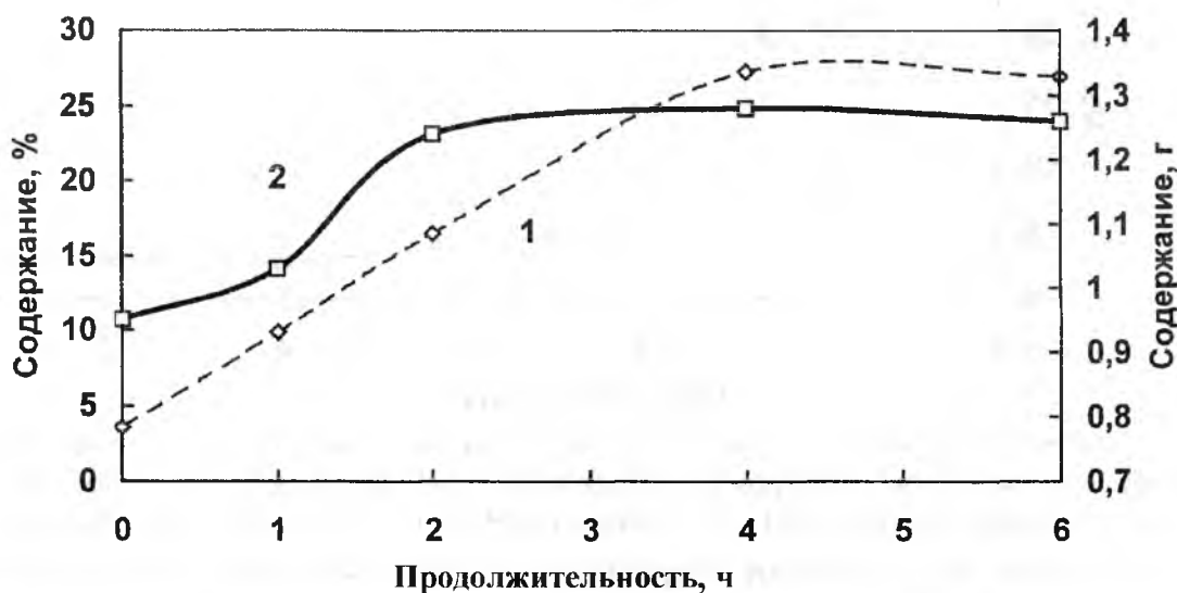
Рис. 5. Изменение абсолютного и относительного количества липидов в осадке в процессе гидролиза отходов промысла гребешка: 1 – масса липидов в г; 2 – массовая доля в %. (Условия гидролиза: pH 6,5; температура 50°C; 6 ФП/кг ОПГ; гидромодуль 1:1)
